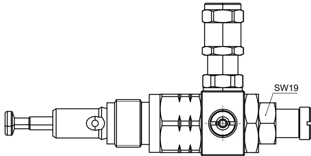
Zur Änderung der Nennförderleistung der Pumpe ist es notwendig, die Gegenmutter (Pos. C) zu lockern und die Stellschraube (Pos. B) zu verstellen:
