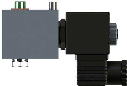
Die Absperrventile SHUT-OFF EV-2 bestehen aus einem Zweiwege-Magnetventil, das "NC" ist, und aus einem Grundelement, das direkt am Einlass der Progressivverteiler angebracht ist.
