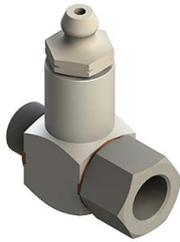
I raccordi **Banjo** si installano all'ingresso o all'uscita del distributore progressivo per poter utilizzare una pompa manuale o pneumatica in caso di non funzionamento della pompa principale.
